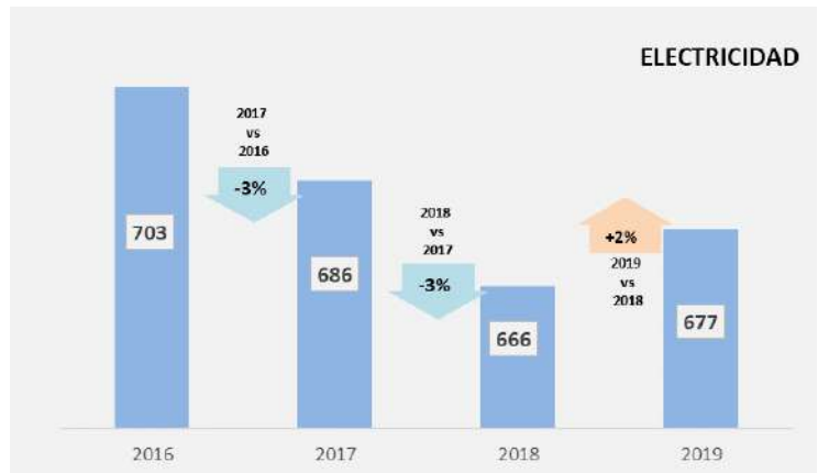
Figura N° 7: Consumo de energía 2016 a 2019 del proceso Molienda y Clasificación. Cifras en GWh.
