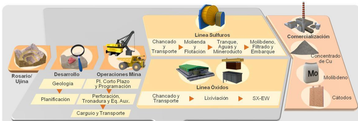
Figura N° 1: Diagrama del proceso productivo del concentrado de cobre, cátodos de cobre, y concentrado de molibdeno de Collahuasi.
